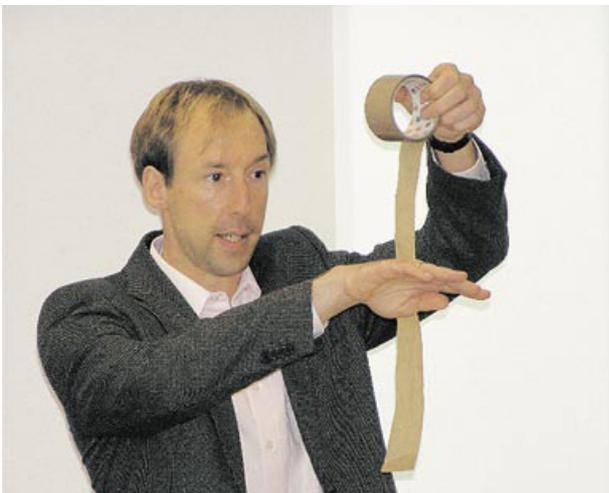
Das Abrollen eines Klebebandes erzeugt große elektrische Ladung
